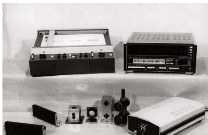
Jedna z prvních verzí laserového interferenčního měřicího systému (LIMS) z produkce n. p. Metra Blansko a vyvinutého v ÚPT.
