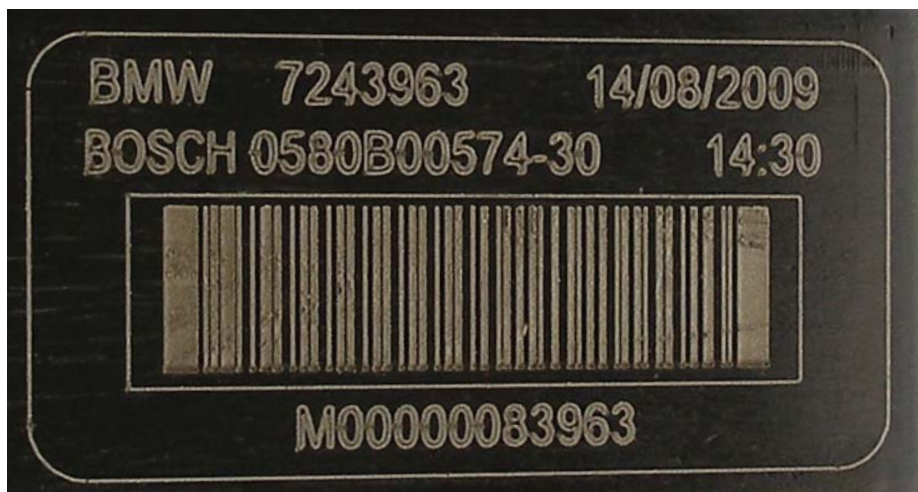
Obr. 1 Popis plastového dílu pomocí laseru
